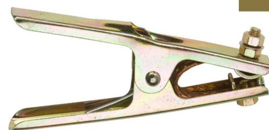
Coquilles en acier galvanisé, contacts en laiton pontés par une tresse de cuivre.
